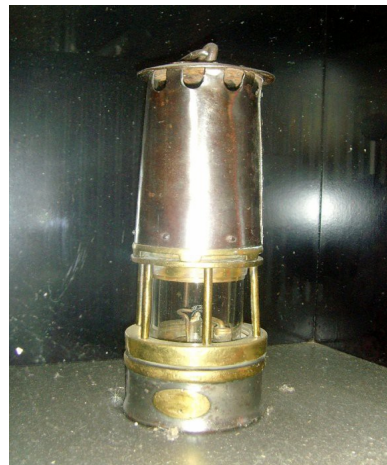
lampe de mineur, modèle Marsaut type Phr
